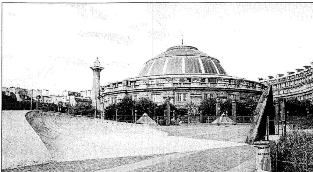
Fig. 12. De glasvezel-zonnewijzer in de Jardin des Halles in Parijs. Het zonlicht valt door gleuven in de monoliet rechts op glasvezels, die naar de kwartier-punten net onder de rand van de golf links lopen. Op de halfronde bank rechts van de monoliet staat o.a. een grafiek van de tijdsvereffening. Op de achtergrond de Beurs met de kolom van de Médicis, waaraan ooit de uurvlakzonnewijzer van Pingré zat [8]
