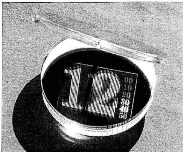
Fig. 9. De huiskamer-versie van de digitale zonnwijzer. Aflezing op enkele minuten nauwkeurig: het getal 40 licht sterker op dan 30; het is dus tussen 12.35 en 12.40 uur.
