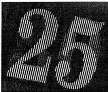
Fig. 5. Vergroot detail uit fig. 1. Elk cijfer wordt door meer dan 20 verticale streepjes gevormd. Tussen elk tweetal streepjes zitten nog 11 andere. Je ziet hier de 0 van 3.30 uur al door de 5 schemeren.
